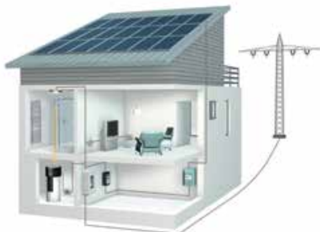
Toplotna pumpa u vezi sa fotonaponskim solarnim sistemom
