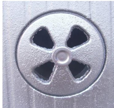
Dovod sekundarnog vazduha - OTVOREN
